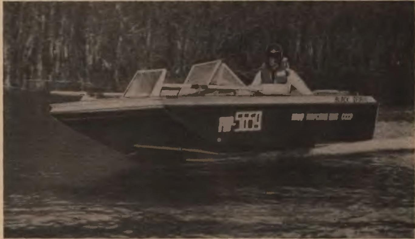
При разработке моей новой мотолодки учитывались следующие требования: пассажировместимость — 5 чел., скорость — около 45 км/ч с одним ПМ «Вихрь-М», мореходность при высоте волны до 1,0 м, комфортабельность и надежность, предельная простота конструкции.
