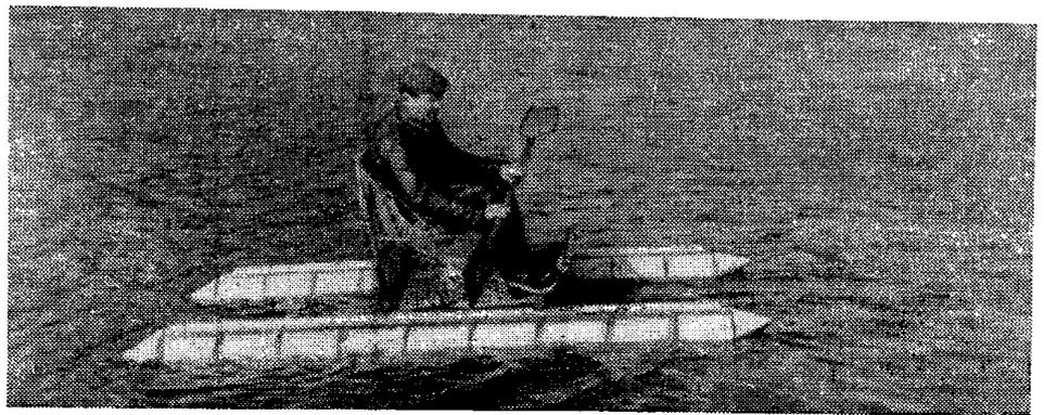
Поверх каждого корпуса уложена продольная балка из рейки 30 × 40 мм, на которую опираются поперечные балки сечением 45 × 40. На эти балки установлено сиденье, изготовленное из старой раскладушки.
