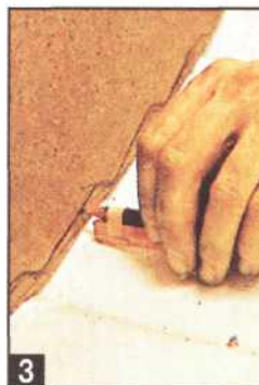
3 Карандашом с деревянной дистанционной шашечкой можно точно нанести контуры стенки корпуса на заготовку.
