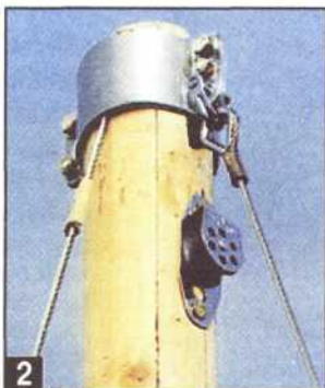
2 Оснастка мачты: ванты пропускают через верхний элемент и закрепляют самодельным хомутом. Фокштаг крепят с помощью скобы.
