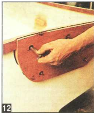
12 Сверлят в корме и усиливающем элементе отверстия под болты М6 с круглой головкой. Вставляют изнутри в отверстия болты, навинчивают на них снаружи и затягивают гайки. Обрезают и зачищают выступающие концы болтов.
