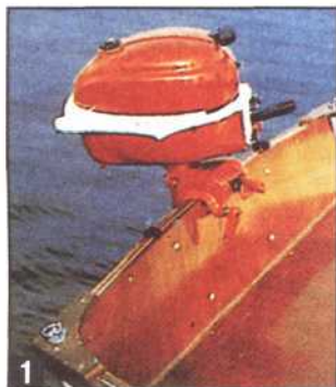
1 Для любителей быстрой езды рекомендуем подвесить мотор мощностью 4-5 л.с., прикрепив его к усиленному транцу лодки.
