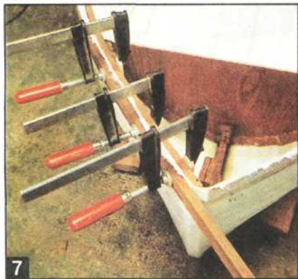
7 Скрепляют струбцинами обе рейки. Сверлят через каждые 10 см изнутри и снаружи отверстия под шурупы \varnothing 4 \times 35 мм. Закрепляют шурупами рейки.
