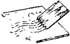
Рис. 46. Шпатель для нанесения клея.
